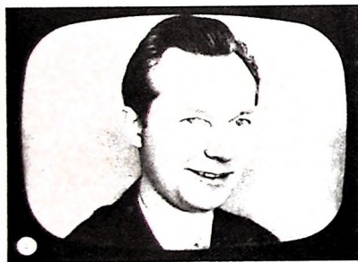
Bild 22. Unretuschierte Schirmbildaufnahmen: a) RMA-Testbild, b) Spezialtestbild, c) Porträt bei einer Beleuchtung von 300 Lux
